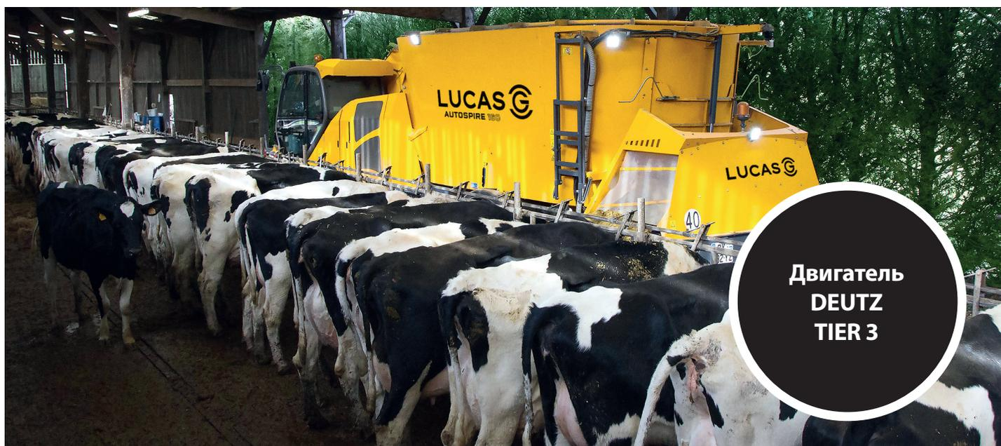
Самоходный кормосмеситель Autospire спроектирован для возможности ежедневных поездок на расстояние более 70 км. Машины оснащены широкой грузовой резиной и дисковой системой торможения на 4 колеса для хорошей устойчивости на дороге и оптимальной безопасности при 40 км/час. Передняя гидропневматическая подвеска и задняя параболическая подвеска обеспечивают гибкость и комфорт для водителя.
